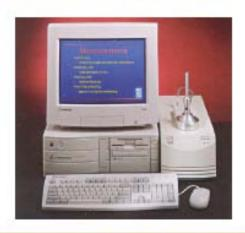
2. ThermoVac degassing station<sup>6</sup>
